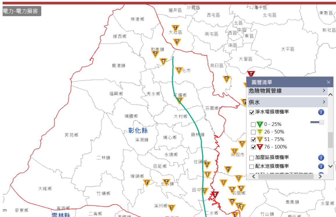
圖 1-3-10 模擬淨水廠損壞機率
